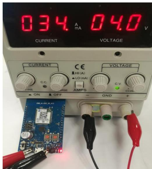
**注意：**当使用 5V 供电方式的时候，由于 PC 的 USB 口供电峰值最大只到 500mA，低于 GSM 系统要求 2A 供电能力的需求。在一般的软件调试和一般的使用时没有问题，但是在模块进行长时间连续射频发射时，模块供电端会有电压跌落，造成电源电压不稳定的现象，所以如果在测试长时间连续 GPRS 发射时，有可能会导导致几率掉电关机的现象，因此，在测试长时间连续 GPRS 发射的应用时强烈推荐用锂电池供电或用供电能力大于 2A 的直流电源供电。
