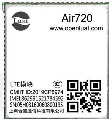
Air720 是合宙通信推出的 LTE Cat.4 系列模块，3229 (32mm\*29mm\*2.4mm) 经典封装；采用 LTE 3GPP Rel.9 技术；支持最大下行速率 150Mbps 和最大上行速率50Mbps。
