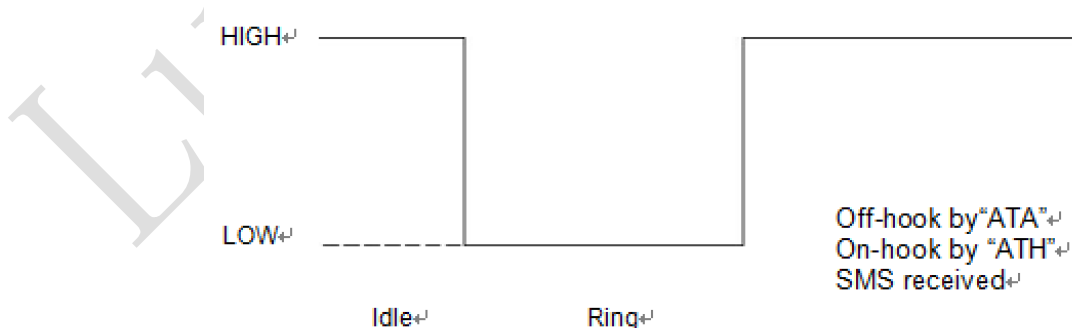
图表 14: 语音呼叫时模块用作被叫方 WAKEUP_OUT 时序
