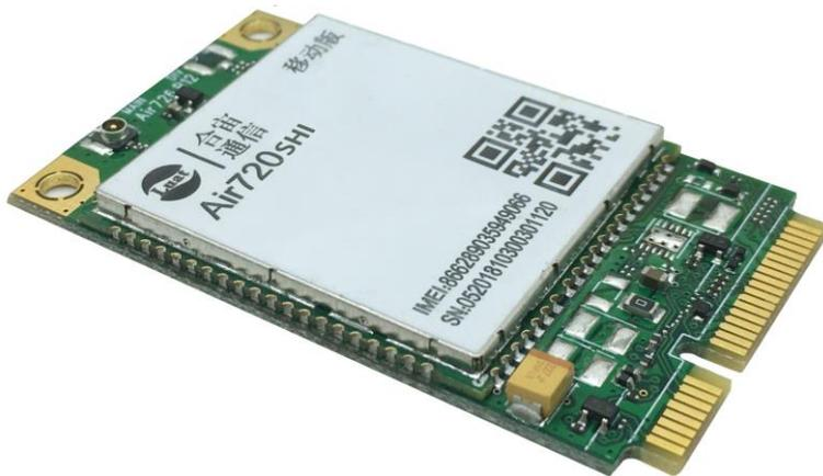
Air720SHI 是合宙通信推出的一款中国移动订制版 LTE Cat.4 MiniPCIe 模块，采用 LTE 3GPP Rel.9 技术，支持最大下行速率150Mbps 和最大上行速率 50Mbps。
